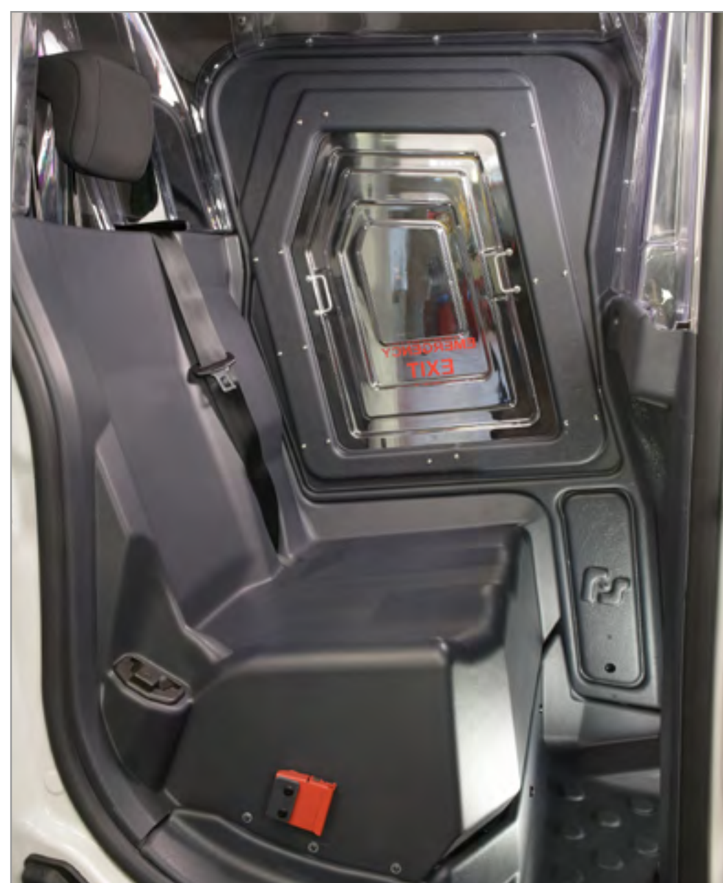
Siège du retenu totalement isolé
