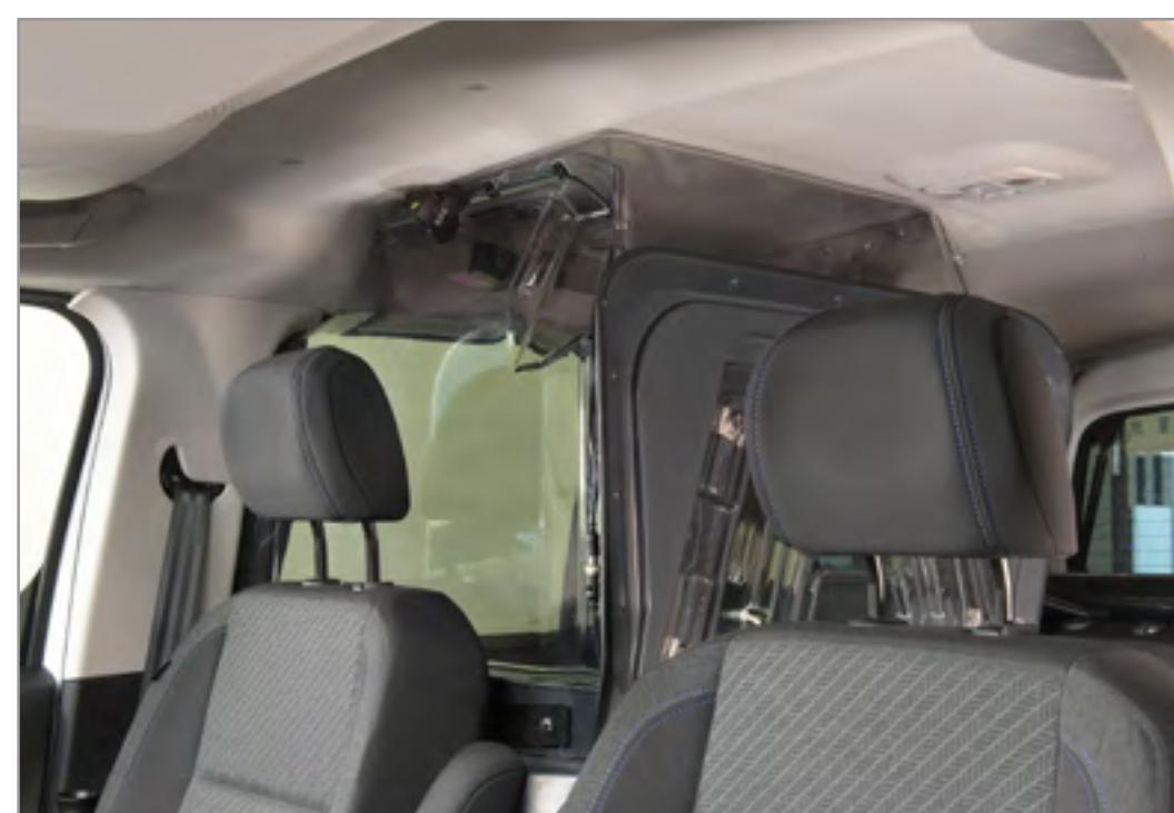
Cloison de séparation vue de face
