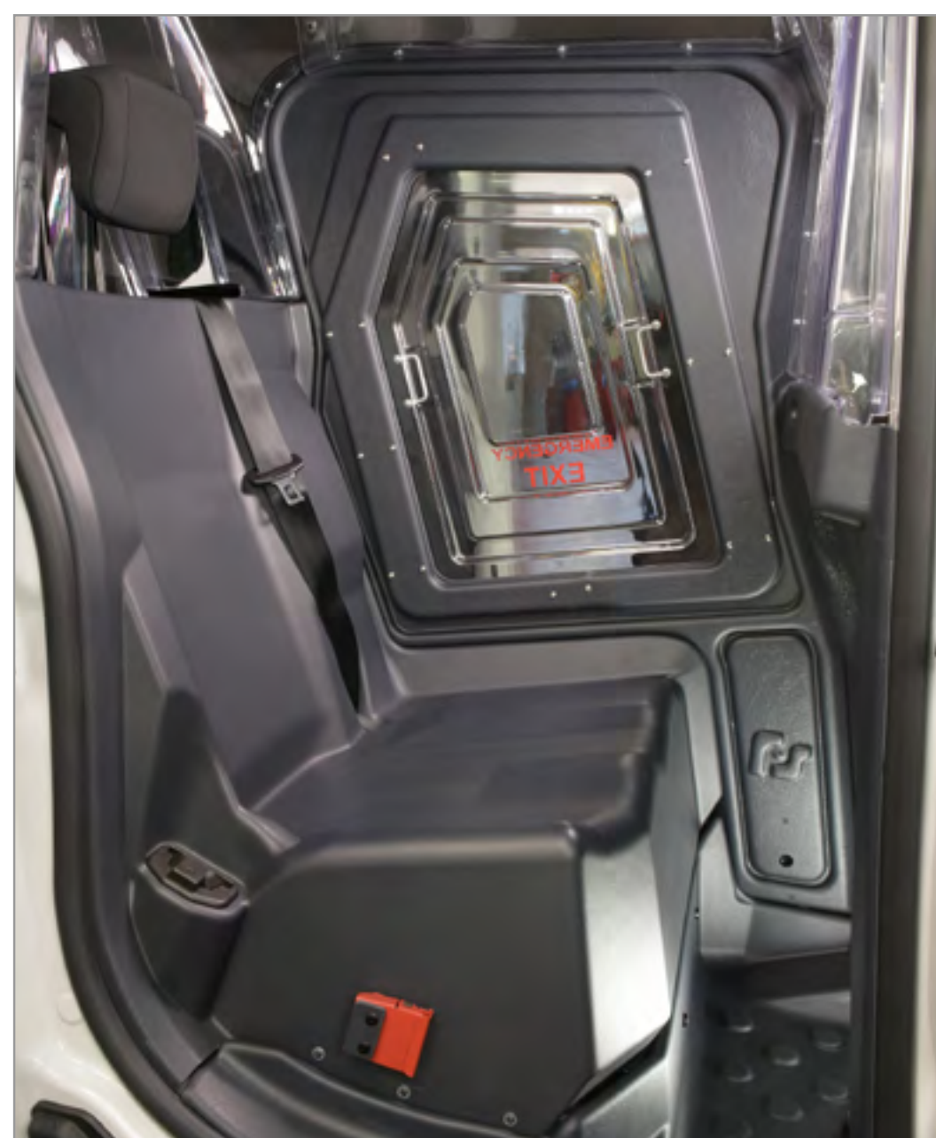
Siège du retenu totalement isolé
